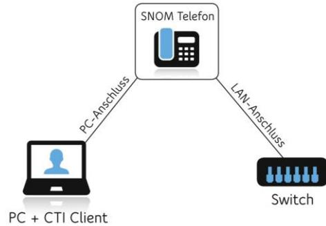
Stromspeisung über das LAN (IEEE 802.3af Power-over-Ethernet) ist bei allen Telefonapparaten (Snom 300, 320, 360 und 370) ebenfalls möglich. In diesem Fall ist für den Telefonapparat kein externes Netzteil notwendig.
